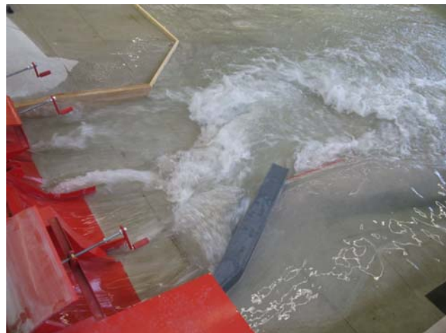
Optimierte HWE im Bemessungsfall (Modell)
